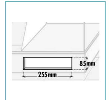
En apparent sur les plinthes ou un meuble de cuisine, ou dissimulée sous un élément de cuisine, l'installation se fait très facilement.
