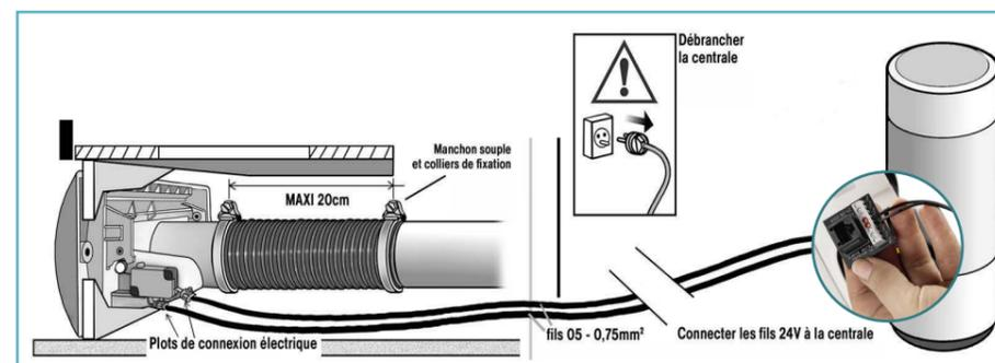
**Rappel** : même avec le système de commande Radio, il est impératif de prévoir le raccordement électrique de la centrale pour la prise ramasse-miettes.
